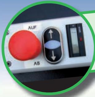
Die Steuerung erfolgt über ein Zweitasten-Bedienteil mit Zählwerk
