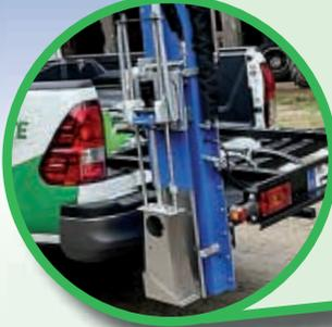
Der N 2006, zur Zeit der modernste und schnellste Bodenprobenehmer auf dem Markt, ist ein bohrendes System für Entnahmetiefen von 10-30 cm.
