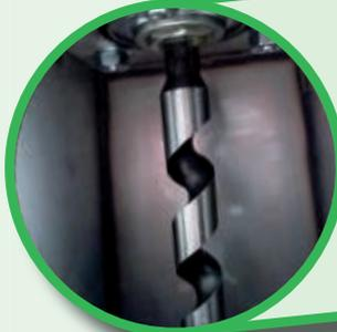
Durch den Spezialbohrer läßt sich eine präzise Bodenprobe gewinnen: Er schraubt sich wie ein Korkenzieher in das Erdreich und gewährleistet dadurch, dass aus allen Ebenen eine gleichmäßige Menge Probematerial entnommen wird.
