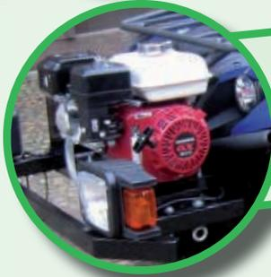
Der N 2006 ist standardmäßig mit einem eigenen Hydraulikaggregat ausgerüstet und somit unabhängig von der Bordhydraulik der Trägerfahrzeuge.
