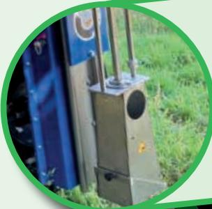
Auch bei sehr harten Bodenverhältnissen und geringem Gewicht des Trägerfahrzeuges erreicht der N2006 zuverlässig die gewünschte Entnahmetiefe.
