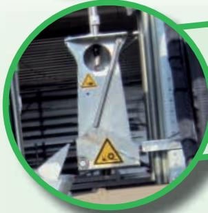
Der konische Behälter ermöglicht eine bequeme Entnahme des Probenmaterials.
